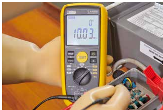
Moottorille suoritettava ennaltaehkäisevä kunnossapitomittaus
