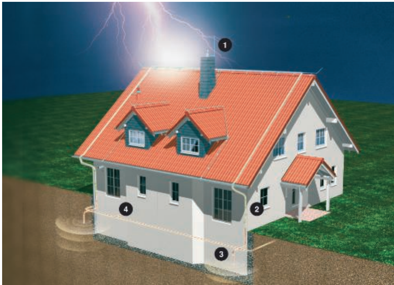
1 = sieppausjärjestelmä 2 = alastulojohtimet 3 = maadoitusjärjestelmä 4 = potentiaalintasaus
