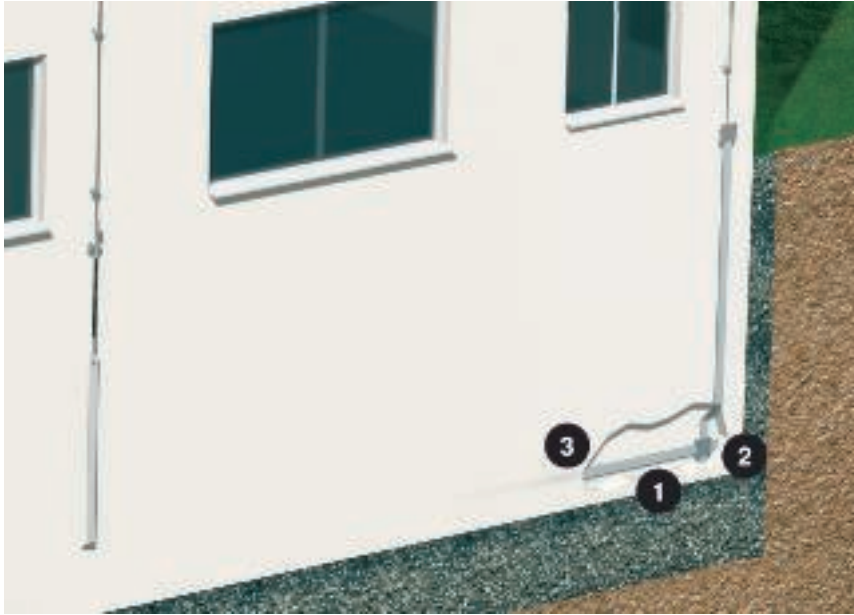
1 = lattajohto 2 = ristiliittimet 3 = korotuskappaleet
