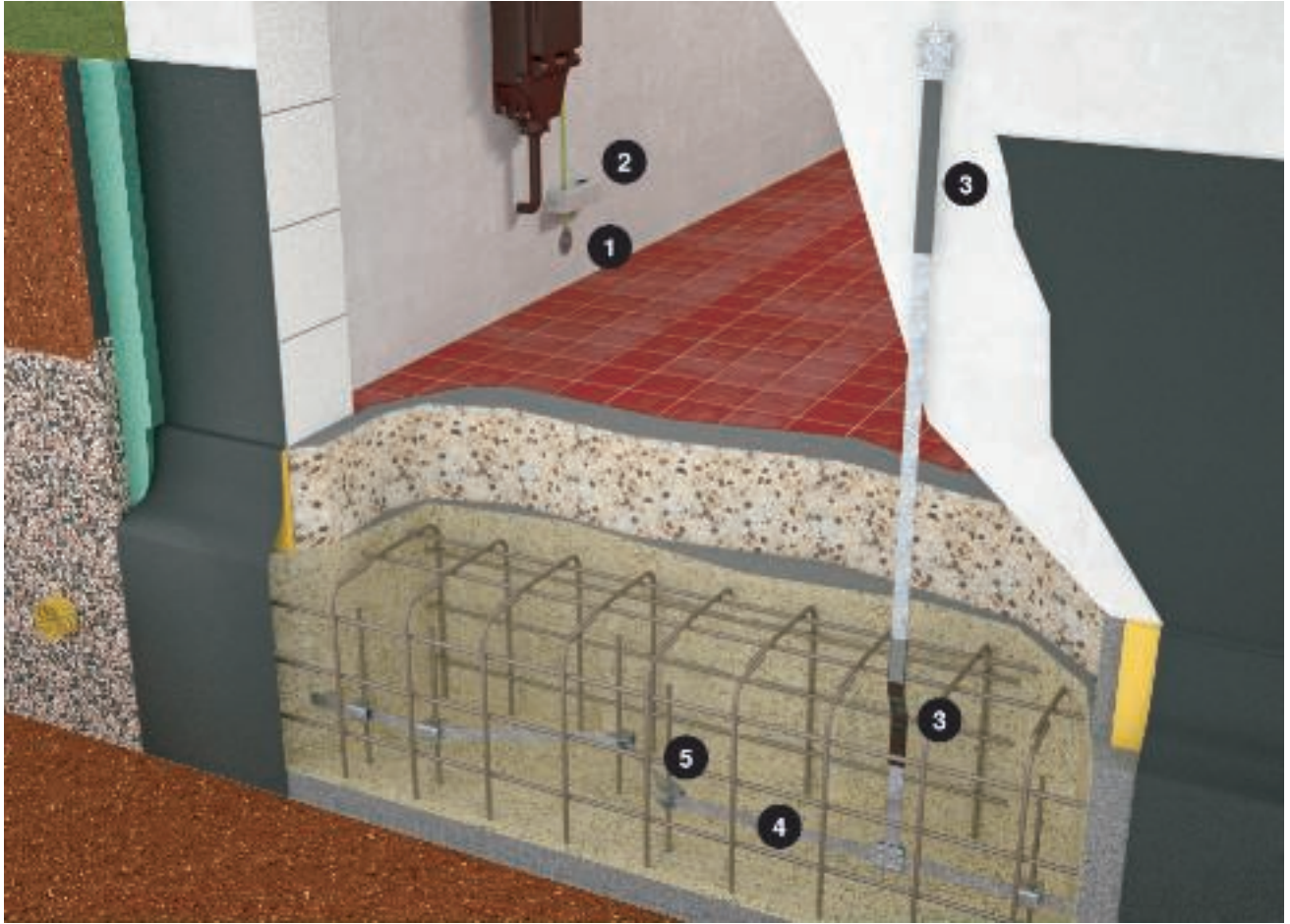
1 = maadoituspiste 2 = päämaadoituskisko 3 = korroosiosuojanauhat 4 = johtimet 5 = liittimet
