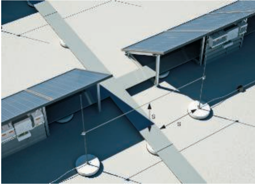
Kuva 1: Erotusväli (s) salamasuojauksen ja kaapelijärjestelmien välillä
