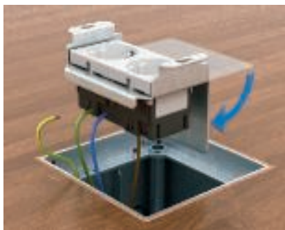
Pistorasian asennus kanavakalusteeseen Pistorasia lukitaan metalliseen lasennuslevyyn ja johdot kytketään. Kun PE-johdin on kytketty asennuslevy taitetaan 90°.
