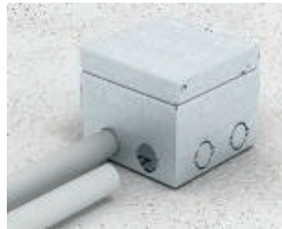
Asennusputkien liittäminen Asennusputket M25 asennetaan aihioihin enintään 5mm syvälle.
