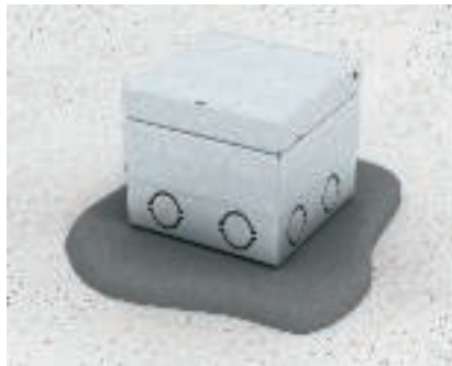
Valun syvyyteen sovittaminen Jos valun syvyys on yli 95 mm, lattiarasian alle tehdään kuormitusta kestävä tasainen tukipinta.
