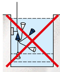
Kuva 6. Vältä kiinnittämistä niin, että kaapeli taittuu terävän mutkan vuoksi.
