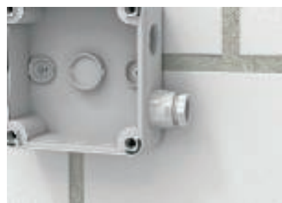
Asennus holkkitiivisteillä ilman vedonpoistoa Holkkitiiviste ilman vedonpoistoa, lyhyellä kiertellä ruuvataan rasiassa olevaan kierteseen. Lävistyskalvoa ei tarvitse poistaa.
