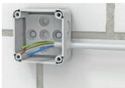
Kaapeleiden sisäänviennit kalvotiivisteellä Kalvotiiviste avataan johdon halkaisijan mukaan. Sen jälkeen kaapeli viedään jakorasiaan.
