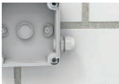
Asennus V-TEC-holkkitiivisteellä Holkkitiiviste, V-TEC, lyhyellä kiertellä ruuvataan rasiin kierteseen. Lävistyskalvoa ei tarvitse poistaa.
