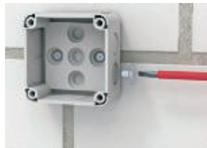
Kaapeleiden sisäänviennit VBX 25 VBX 25:n aukot voidaan avata helposti ja siististi mukana toimitetulla työkalulla.
