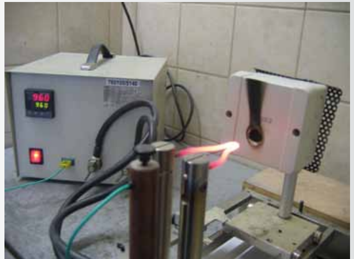
Nach 30 Sekunden wird die Glühdrahtschleife abgenommen und die Flamme soll erlöschen After 30 seconds the glow wire will be removed and the flame should extinguish
