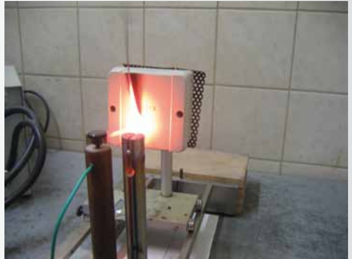
Es kann zum "Flashover" kommen und das Produkt entflammt It may lead to a flash-over and the product will ignite into flame
