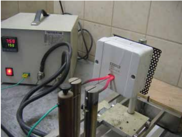
Die Glühdrahtschleife wird gegen das Gehäuse geführt The glow wire is placed against the box
