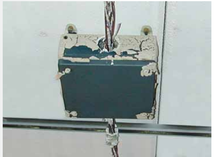
Bild nach einer Feuerwiderstandsprüfung. Die Funktionsfähigkeit wurde über 90 Minuten bei einer Endtemperatur von über 1000 Grad Celsius geprüft. IP 20-Schutz besteht, die elektrische Funktionsfähigkeit im Brandfall ist gesichert. Figure after a fire resistance test, intrinsic resistance to fire was tested for 90 minutes with a final temperature of more than 1,000 degrees Celsius. IP 20 protection provided, electrical intrinsic resistance to fire is assured in the event of fire.
