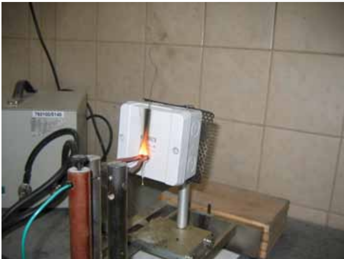
Brennendes, abfallendes Material darf die leicht entflammare Unterlage nicht entzünden Burning, falling material must not ignite the flammable base
