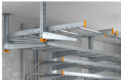
Profiilikannakkeeseen US 5 kiinnitetään AW 30 kannake ruuvisarjalla SKS 10x90 ja väliin asennetaan DSK 45 tukikappale. Tikashylly kiinnitetään AW 30 kannakkeeseen LKS 40 kiinnityskappaleella.
