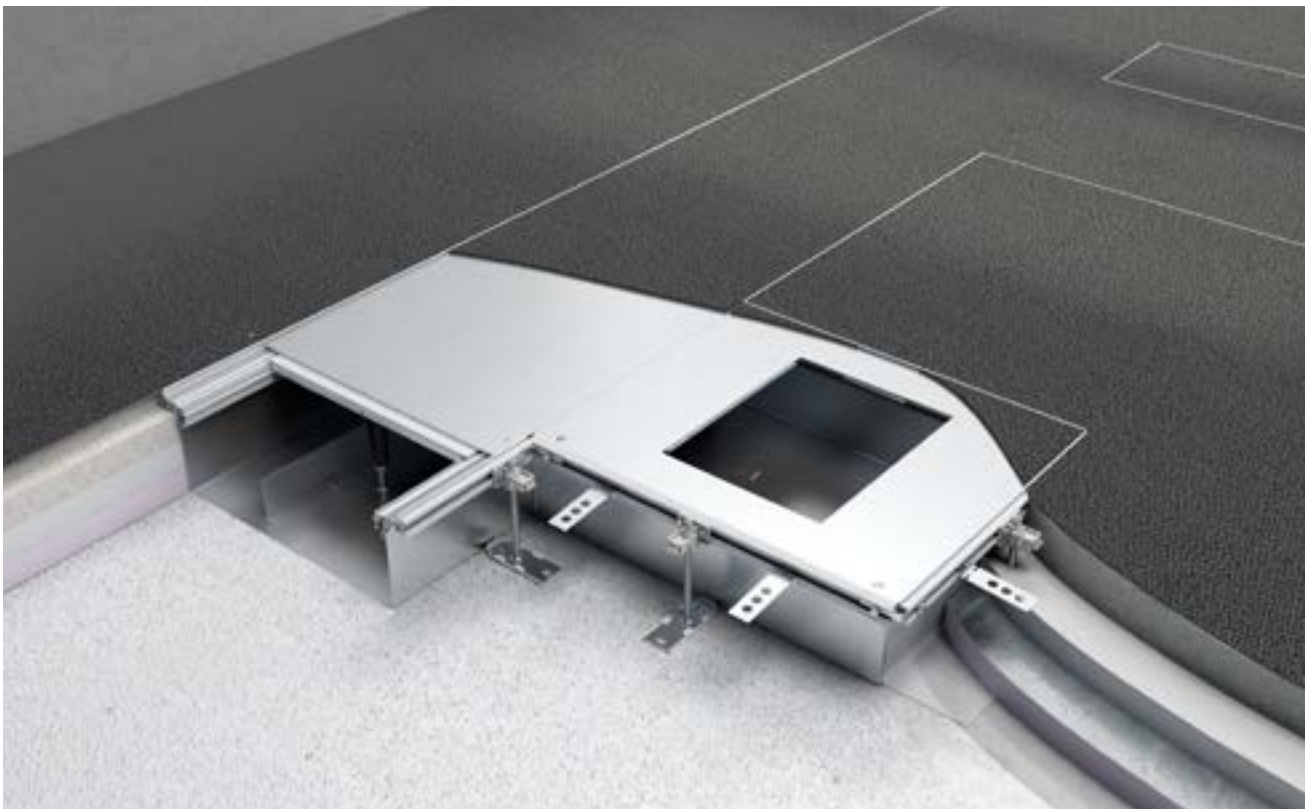
Lattiapinnoite asennetaan kansiin ja valuun. Lattiapinnoitteiden väliin asennetaan saumaprofiili joka estää lian pääsemisen väliin. Kannen alle voidaan asentaa tiiviste, jolloin kanava soveltuu myös märkäpuhdistettaviin lattioihin EN50085-2-2.
