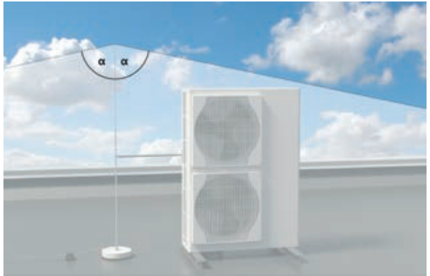
Katolla olevan sähkölaitteen suojaaminen suojakulmamenetelmällä.
