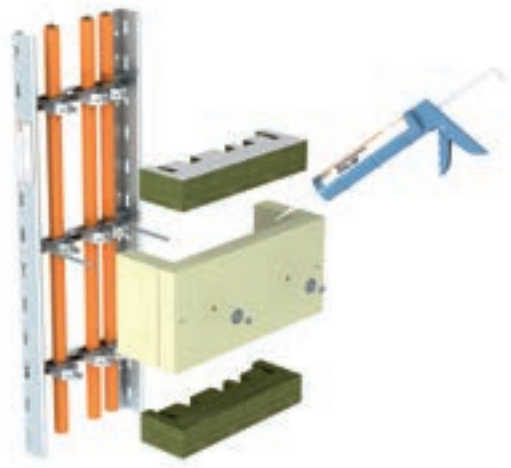
Kaapelit kiinnitetään pienoihin kaarikiinnikkeillä. Sopivat kiinnikkeet löytyy kiinnike-osiosta.
