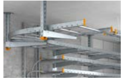
Profiilikannakkeeseen US 5 kiinnitetään AW 30 kannake ruuvisarjalla SKS 10x90 ja väliin asennetaan DSK 45 tukikappale. Tikashylly kiinnitetään AW 30 kannakkeeseen LKS 40 kiinnityskappaleella.
