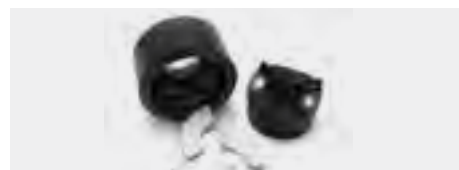
Pyöreät lävistimet läpivientien tekemiseen sekä metri- että PG mitoituksella.
