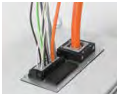
Useamman kaapelin läpivienti. Mukana valmis-kaapeleita liittämiseen ja perusläpimenoa ilman liittimiä olevilla kaapeleilla. Moduulilaipan asennusaukko 314x144 mm.
