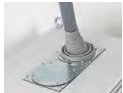
Syöttökaapelin läpivienti kotelon katolla moduulilaippaa hyödyntäen. Asennusaukko 314x144 mm.
