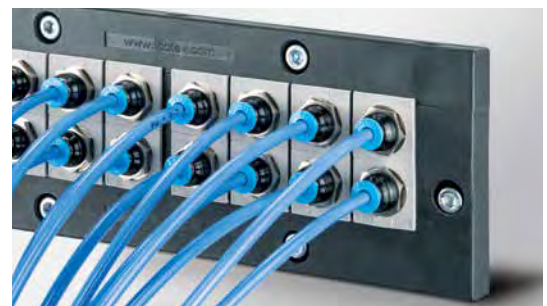
KEL-U 183-E16 kalustettuna 16 x AT-K-M tiivisteosilla (12x1.5), joihin liitetty 16 x pneumaattisia Schott plug-in liittimiä.
