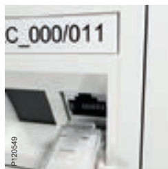
Liittimet käännetty johtojen irroittamisen helpottamiseksi.
