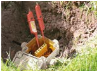
Kovettunut joustava geeli antaa vedenpitävän suojan – IP68. Geeli toimii myös johtimien vedonpoistimena. Sähkömittaukset voidaan tehdä geelin läpi – se tiivistyy itsestään.
