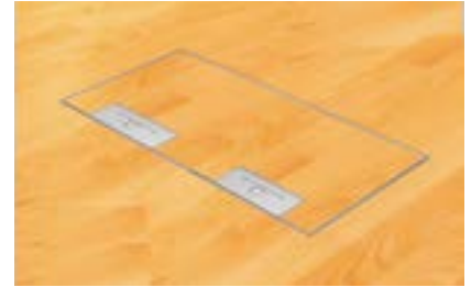
UKL-2 500 KR 6x3 modulia min. Ø185mm onteloon Aukkovaraus 260x530mm 2-25mm lattiapinnoitteille Kannessa 10mm upotus lattiapinnoitteelle
