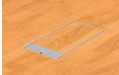
UKL4 KR 1x4 modulia min. Ø100mm onteloon Aukkovaraus 160x300mm 2-25mm lattiapinnoitteille Kannessa 15mm upotus lattiapinnoitteelle
