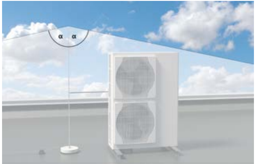
Katolla olevan sähkölaitteen suojaaminen suojakulmamenetelmällä.
