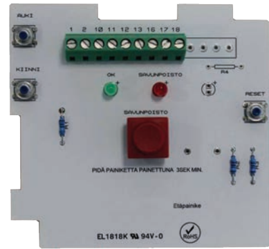
3S5-SW-Etäpainikkeen elektronikkakortti
