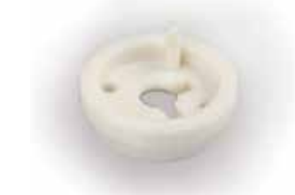
Akselin ohjausrenkas KSH48-vääntimelle, PMR716.1/U. Mahdollistaa oven avaamisen sekä ON että OFF -tilassa.
