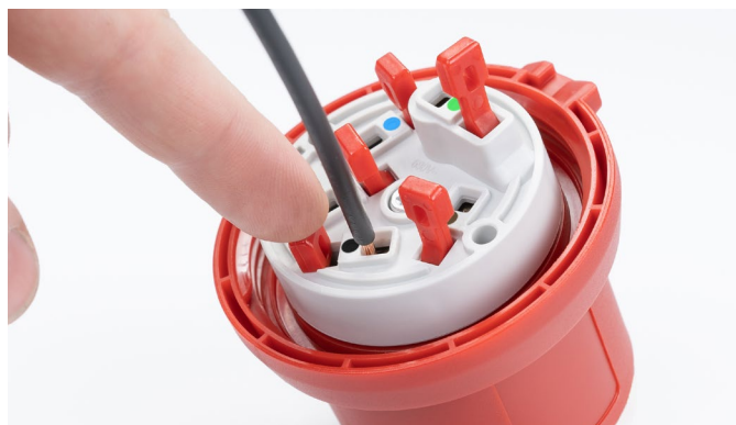
Aseta johdin avoimeen liittimeen ja lukitse se sisään napsauttamalla
