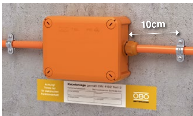
Ensimmäinen kaapelikiinnike toimii vedonpoistona 10 cm etäisyydellä jakorasiasta.
