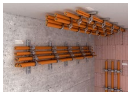
Kaarikiinnikkeitä käytettäessä kiskojen väli oltava 300mm. Kaarikiinnikkeillä voidaan kiinnittää kaapeleita max Ø100mm. Kaapelinipussa saa olla enintään 3 kaapelia halkaisijaltaan max 25mm.
