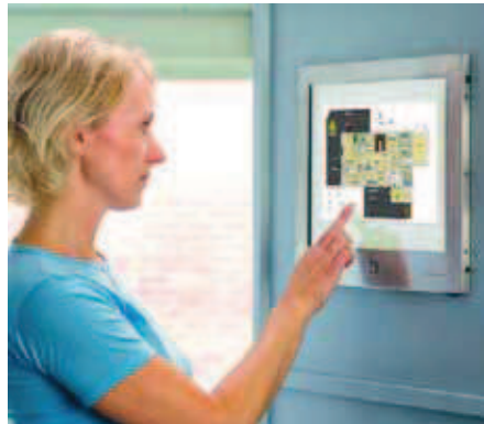
Valaistuksen ohjaus, autonlämmityksen ajastus, huonekohtaisen lämpötilan mittaus ja säätö tai internetin selailu onnistuu kätevästi kosketusnäytön graafisella käyttöliittymällä.
